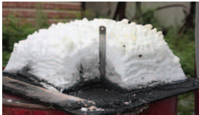
Рис. 3. Теплоизолирующий слой огнезащитного покрытия, вспучившийся под воздействием высоких температур
